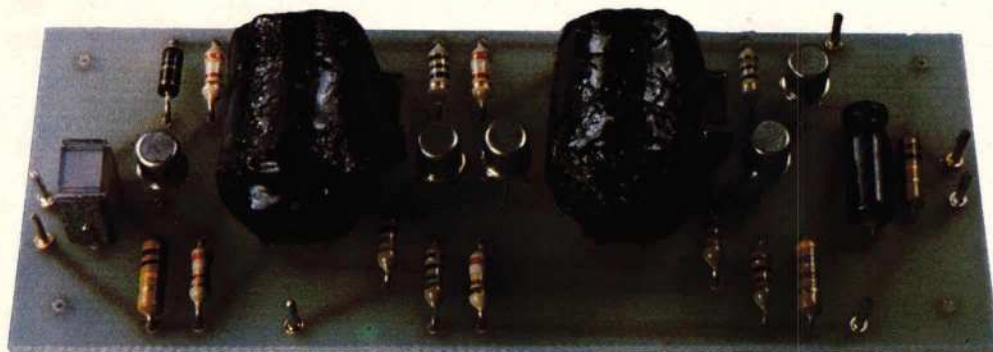
Afb. 9 De complete fasedraaierprint met beide optische koppelingen. De hier afgebeelde koppelingen zijn in zwart isolatieband gewikkeld en glad gemaakt met albastine. Tot slot zijn ze mat-zwart geverfd.
