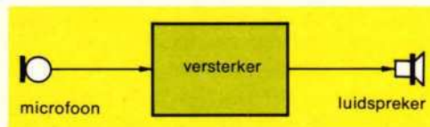
Fig. 2 Eenvoudig principe schema, waarbij het LF-signaal gaat van microfoon via versterker naar luidspreker.
